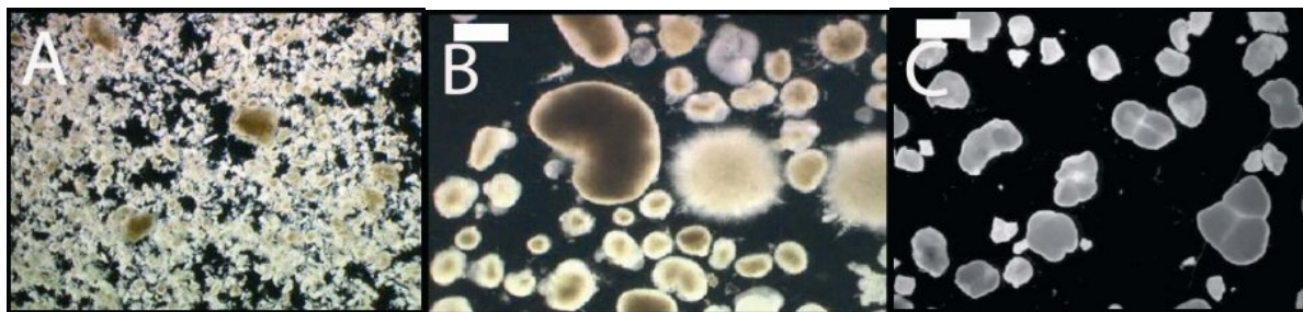
Figura 18.8 Desarrollo de un lodo aerobio granular en un reactor secuencial airlift semicontinuo, inoculado inicialmente con lodos activados convencionales, después de 4 (A), 13 (B), y 87 (C) días de operación del reactor (escala= 1 mm) (Imágenes: M.C.M. van Loosdrecht)
