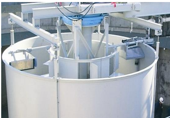
Figura 12.7 Pozo de floculación (foto: Brown y Caldwell)
