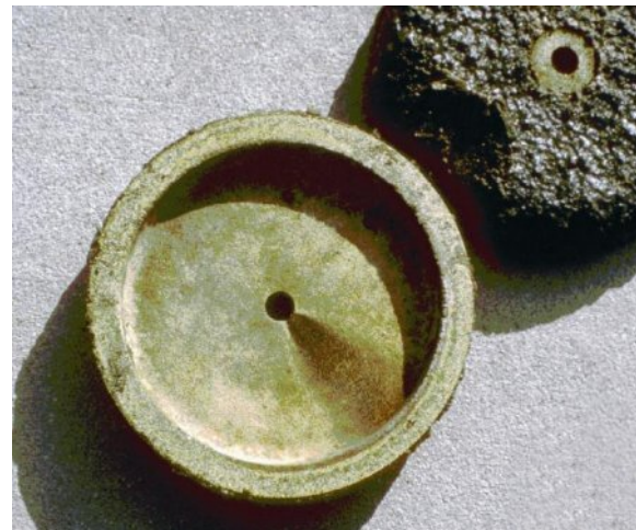
Figura 9.8 Primera generación de difusores de poro fino: domos o discos cerámicos. El aire es alimentado a través de un tubo o una conexión conectados a la ranura central del disco o domo, el cual es liberado a través de los poros. La fotografía de la derecha muestra un difusor después de un uso prolongado, se puede observar un deterioro considerable en la superficie externa causado por la acción de los microorganismos. La zona más oscura observada dentro del disco o domo muestra la posición de la tubería o conexión del sistema de suministro de aire y, debido a las manchas dejadas por los contaminantes, se puede notar la trayectoria de ciertas fugas del sistema de aireación (fotos: M.K. Stenstrom)
