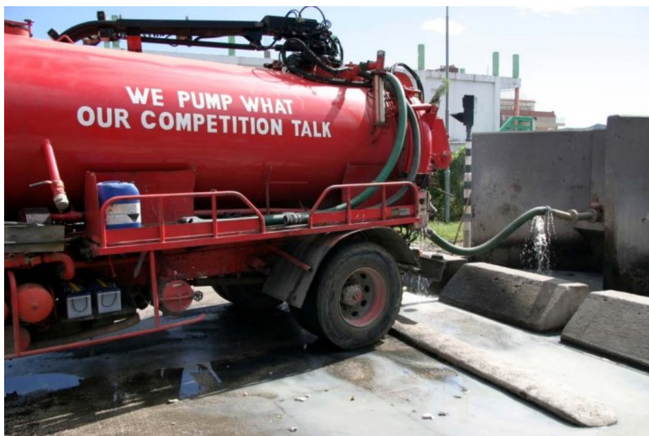
Figura 3.5 Camión cisterna descargando el contenido de fosas sépticas de hogares en un tanque de almacenamiento en la planta de tratamiento de Illidge Road en St. Maarten, N.A. (foto: D. Brdjanovic)
