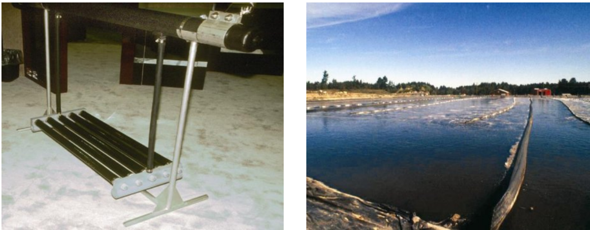
Figura 9.11 Aplicación de difusores de burbuja fina a una laguna aireada. Los tubos de suministro de aire (ubicados sobre el bastidor de difusores) distribuyen el aire a lo largo de la laguna, y las mangueras verticales transportan el aire de los tubos de suministro a los bastidores de los difusores (ubicados cerca del fondo de la laguna) (fotos: M.K. Stenstrom)
